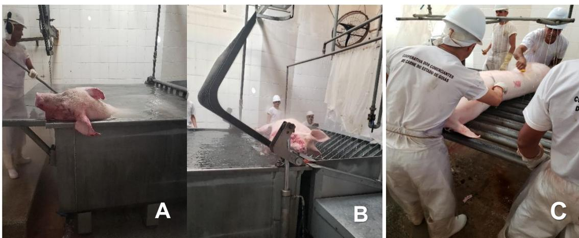
FIGURA 7 - Escaldagem (A), Depilação Mecânica (B) e toaleta (C).
